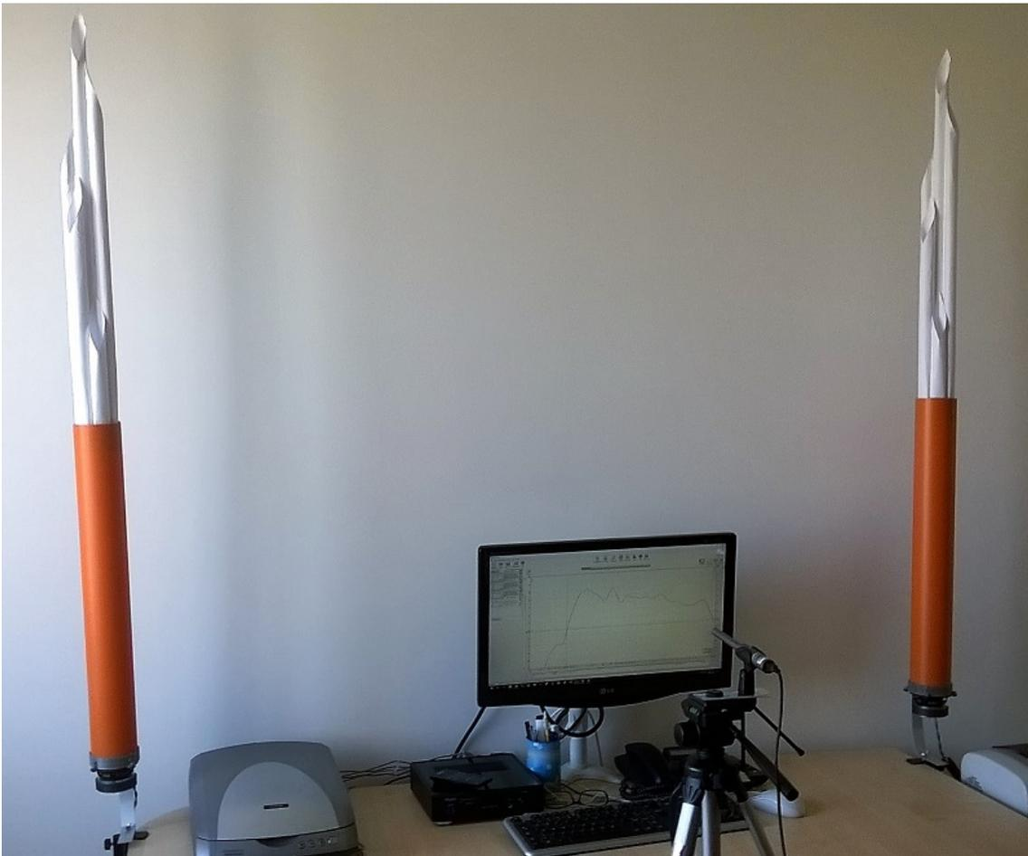
Il progetto 666g ha una guida d'onda a sezione circolare 80 x 600 mm in PVC rigido e una serie di sette guide d'onda in carta di lunghezza crescente (100 – 700 mm). Va fissato con morsetti ai lati del piano di lavoro della scrivania.
