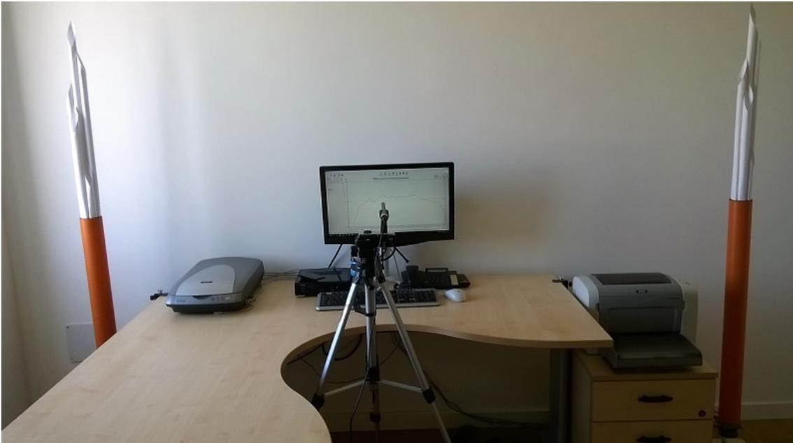
Il progetto 667g ha una guida d'onda a sezione circolare 80 x 900 mm in PVC rigido e una serie di sette guide d'onda in carta di lunghezza crescente (100 – 700 mm). Va posizionato a pavimento ai lati della scrivania.
