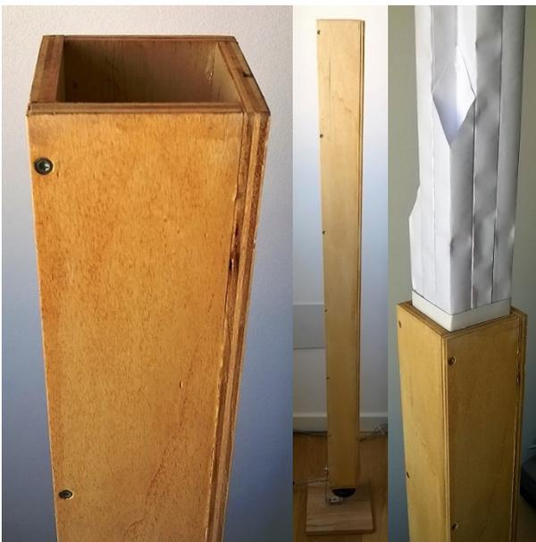
**Sezione 1 e 2.** La sezione quadrata permette di realizzare la parte rigida della guida d'onda in legno e rende il diffusore simile a casse acustiche tradizionali. Nell'esempio che segue si utilizza compensato in pioppo da 10 mm, la lunghezza della guida è di 1200 mm, i lati esterni di 85 mm e il foro interno è di 65 mm.
