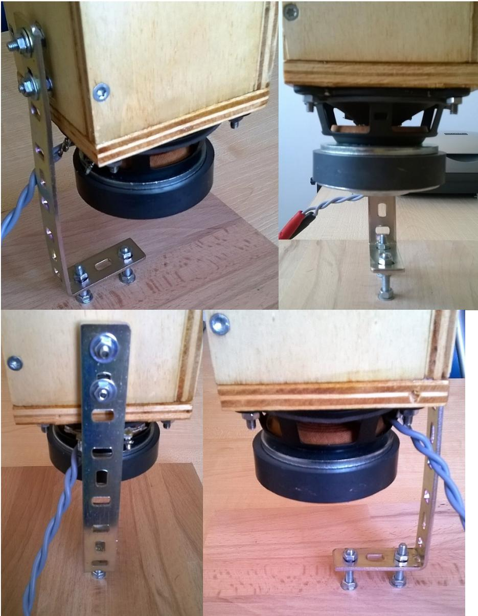
La staffa del supporto subsonico è una elle in acciaio e fissata a una tavola in legno con due coppie viti in per regolare la verticalità.
