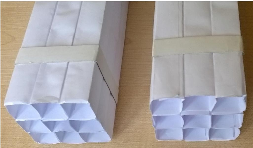
**Sezione 3 e 4.** Le guide d'onda in carta sono nove per motivi geometrici. Ogni guida d'onda in carta è quadrata e ha una sezione di 20x20mm, le lunghezze sono comprese fra 100 e 700 mm. Le nove guide d'onda formano una matrice quadrata 3 x 3.
