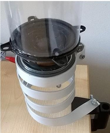
Un morsetto per lampade da scrivania con un vite 5 x 20 mm fa da supporto per la staffa in alluminio.
