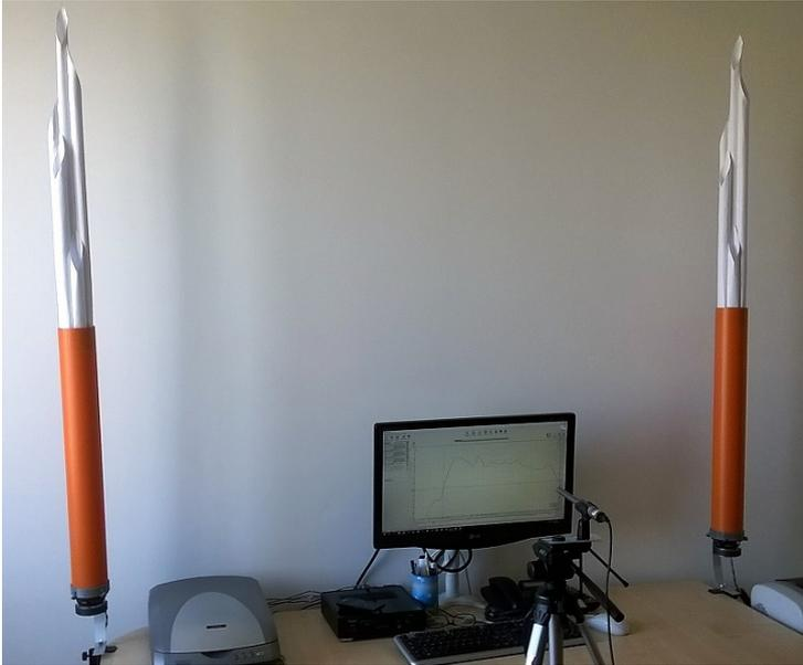
Nel diffusore 666g lo schermo acustico è un tubo in pvc rigido da 80 mm di diametro esterno e circa 75 mm di diametro interno, lungo 600 mm. Si tratta di tubi utilizzati per lo scarico delle acque. Sono proposti tre livelli di implementazioni: molto semplice (a), difficoltà media (b) e alta (c), hanno le stesse sezioni 1 e 2 e differiscono nelle sezioni 3 e 4.
