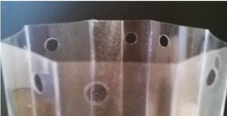
Incollare con il biadesivo il foglio di pvc trasparente di 260 x 1000 mm per ottenere un cilindro alto 1000 mm e con un diametro di 78 mm. Piegare il cilindro per 382 mm rendendo la sezione finale del tubo ottagonale con quattro lati uguali. Dopo la piegatura forare come nella foto con una foratrice manuale da ufficio. Ripetere l'operazione per il secondo altoparlante.
