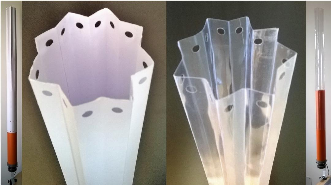
**Sezione 3.** Il limite del foglio A4 è che può generare ritardi supplementari rispetto allo schermo acustico (sezione 2) compresi tra 0 e 0,6 millisecondi. Per aver un intervallo più ampio è necessario utilizzare guide d'onda di lunghezza maggiore. Nella foto sono mostrate guide d'onda realizzate in cartoncino da 250 g/mq e pvc trasparente da 0,25 mm ripiegando la guida d'onda di un diffusore 665g su tutta la lunghezza.
