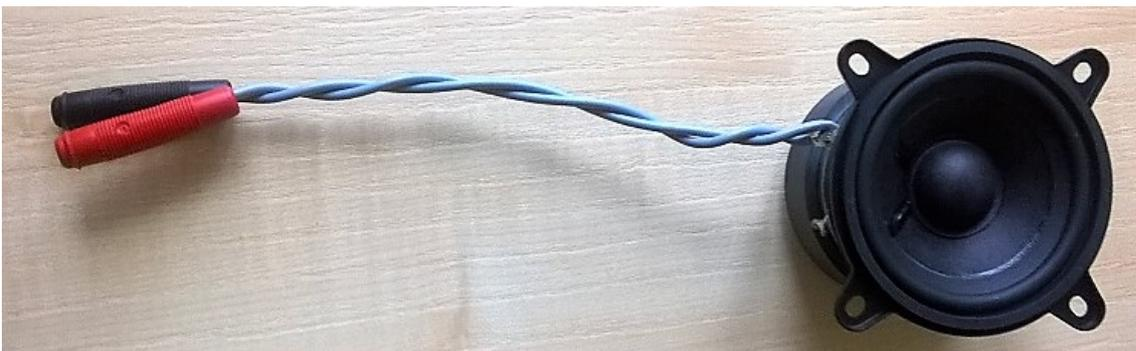
Saldare il connettore rosso allo spezzone di filo lungo 200 mm e saldare l'altro capo del filo al polo positivo dell'altoparlante. Saldare il connettore nero allo spezzone lungo 230 mm e successivamente saldare il filo al connettore polo negativo passando dietro il raggio del cestello dell'altoparlante, in questo modo si evita di creare una
