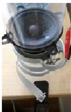
Il filo di collegamento all'amplificatore è esterno e si comporta meccanicamente come elemento smorzante delle oscillazioni. Va sistemato in modo da non provocare vibrazioni spurie né ridurre in modo apprezzabile il tempo di smorzamento dell'oscillazione del diffusore.
