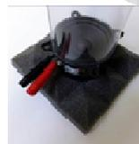
Il diffusore acustico 665g può già essere utilizzato appoggiandolo su una superficie stabile. Un riquadro di gommapiuma riduce le riflessioni generate dal lato posteriore dell'altoparlante e migliora la qualità della riproduzione.
