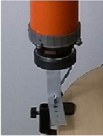
Nella foto è utilizzata una flangia in nylon realizzata con una stampante 3D. Qualunque sistema: viti, colle, elastici, fascette in grado di sostenere il peso dell'altoparlante è adatto.
