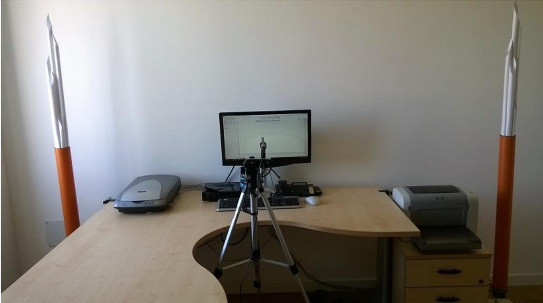
Il progetto **667g** aumenta la risposta sulle basse frequenze aumentando la lunghezza dello schermo acustico in PVC rigido a 90 cm. Il trasformatore acustico (sezione 3) in carta da 90 gr/mq a guide d'onda multiple e di lunghezza crescente è lo stesso del modello 666g. Il suono è sempre dettagliato con una maggiore estensione sui bassi e un'immagine sonora molto ampia. È posizionato sul pavimento ai lati della scrivania.
