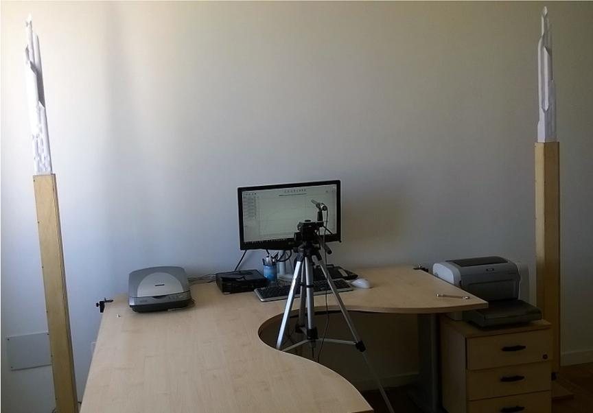
Il progetto **669g** aumenta ulteriormente la risposta sulle basse frequenze aumentando la lunghezza dello schermo acustico a 120 cm, è realizzato in legno con sezione quadrata. Il trasformatore acustico (sezione 3) in carta da 90 gr/mq a guide d'onda multiple (nove) è una matrice 3 x3 di di guide quadrate 20x20 mm. Oltre a estendere la risposta sui bassi si riduce ulteriormente la distorsione. É posizionato sul pavimento ai lati della scrivania.
