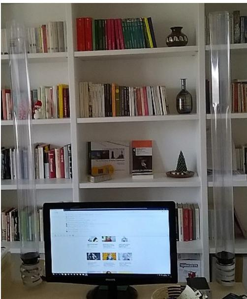
Il progetto **665g** è il più semplice da fare, utilizza una singola guida d'onda con sezioni diverse. Il suono è migliore delle apparecchiature multimediali, ha una maggiore distorsione rispetto ad altri modelli ma soprattutto di seconda armonica. L'emissione di onde secondarie amplia notevolmente l'immagine sonora anche a distanza ravvicinata ed è piacevole da ascoltare. Esteticamente
