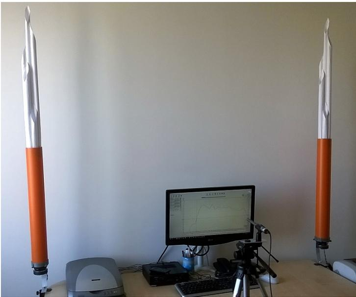
Il progetto **666g** riduce notevolmente la distorsione utilizzando materiali specifici per le diverse sezioni. Lo schermo acustico per i bassi (sezione 2) in PVC rigido e il trasformatore acustico (sezione 3) in carta da 90 gr/mq a guide d'onda multiple (sette) e di lunghezza crescente. Il suono è più dettagliato con bassi più presenti e un'immagine sonora molto ampia.
